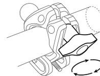
**Étape 6 :** Poussez la rotule dans le joint pivotant et serrez la vis pour fixer le support.
