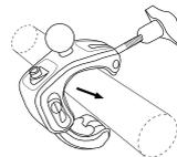
**Étape 5 :** Serrez la vis sur le guidon.
